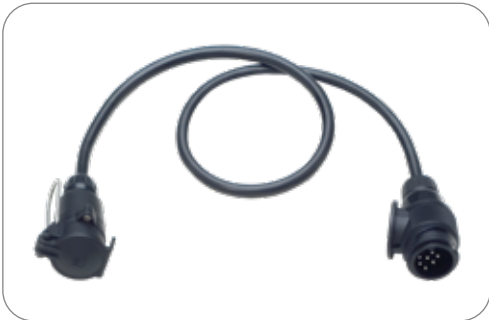
Câble Adaptateur avec fiche de prise 13P/12V (ISO 11446) et coupleur 7P/12V (ISO 1724) Adapter cable with 13P/12V plug (ISO 11446) and 7P/12V coupler (ISO 1724)
